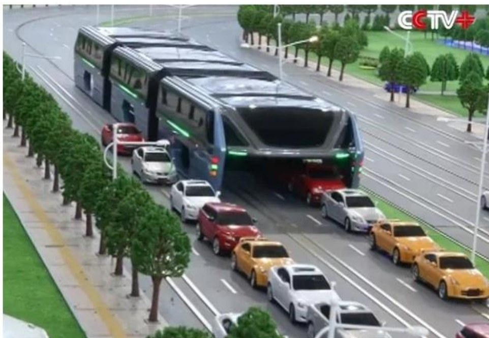
Autobus per il trasporto pubblico sopraelevato, che viaggia su rotaie, senza interferire con il traffico automobilistico
